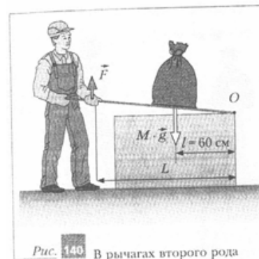
Рис. 140 В рычагах второго рода точки приложения сил находятся по одну сторону от оси вращения рычага
